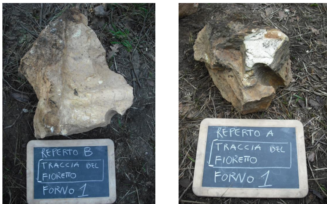
Fig. 5 Tracce di fori circolari su alcune pietre dovute al distacco con attività esplosive.
