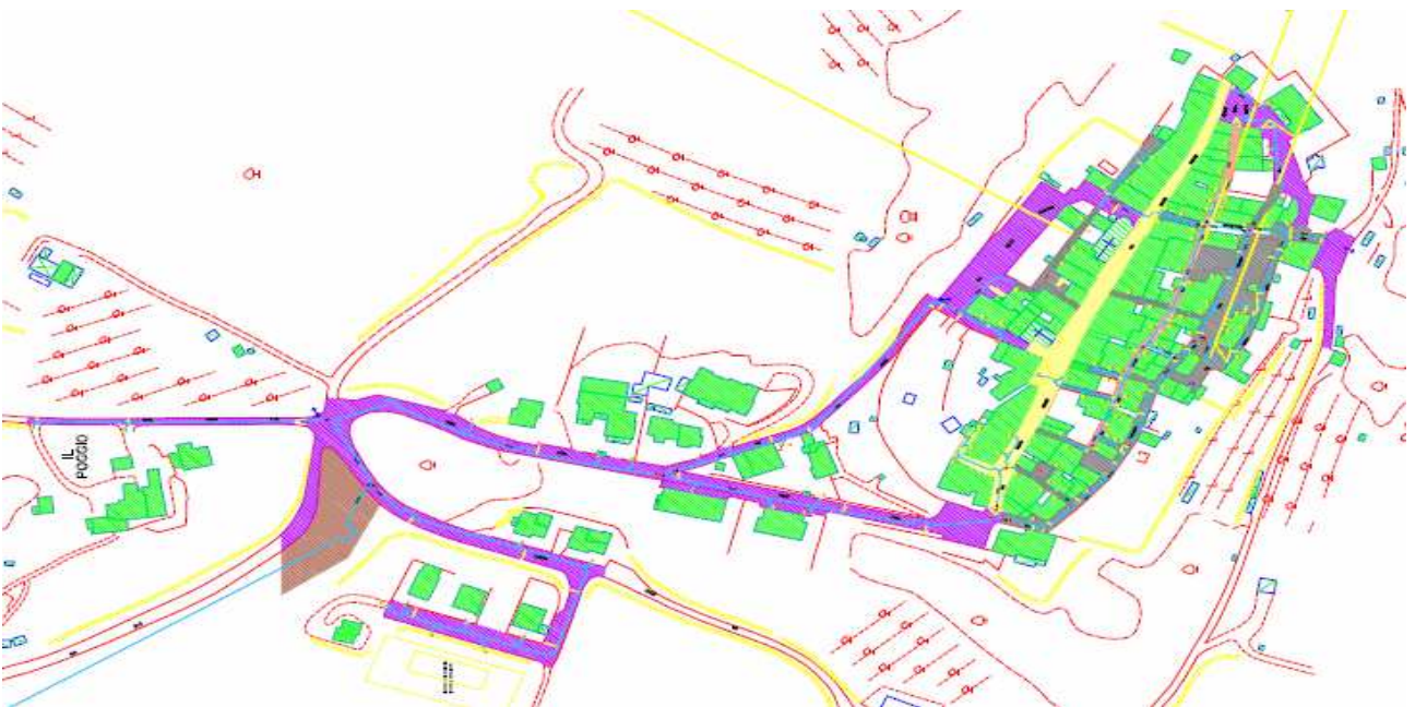
Figura 5 – distribuzione secondaria all'interno del centro abitato di Belforte
