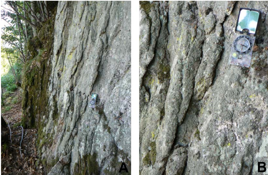
Fig. 3. A: aspetto di una parete nel versante N del poggio 908.4 di Pian delle Mura (il N è verso sinistra); il piano principale della faglia è quello più inclinato e in sua prossimità il blocco di muro mostra delle fratture secondarie con orientazione non casuale. B: un particolare della precedente.
