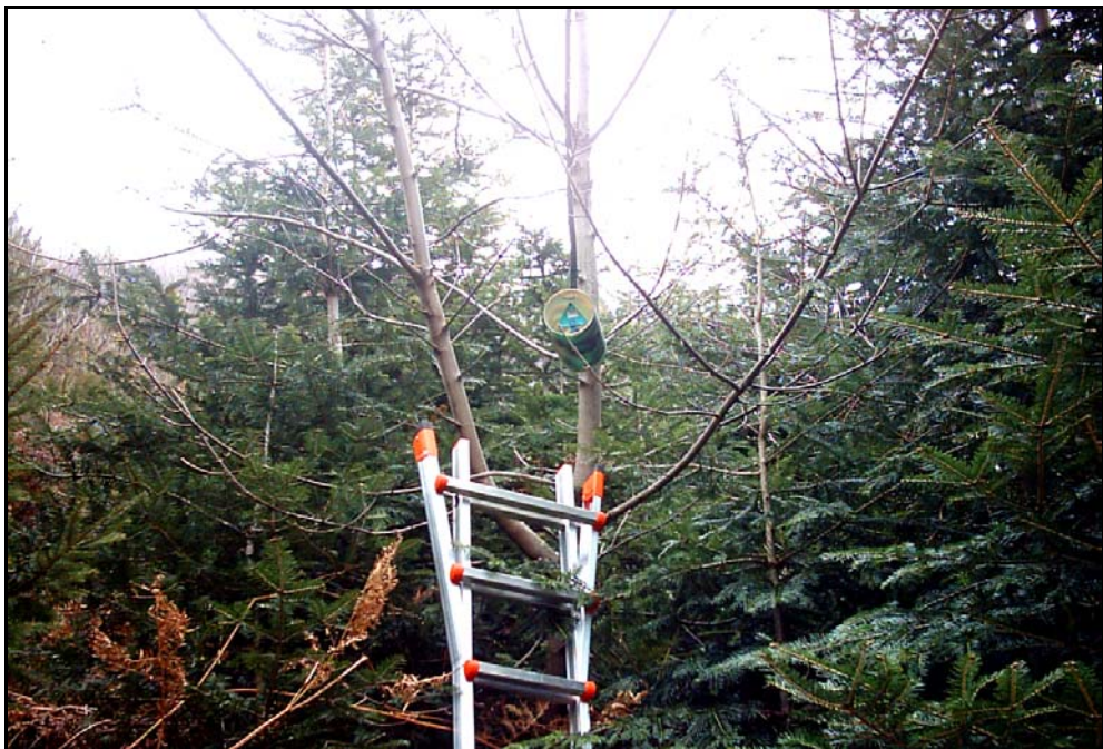
Fig. 13. Posizionamento di un campionatore per la misura della presenza di H_2S in aria.
