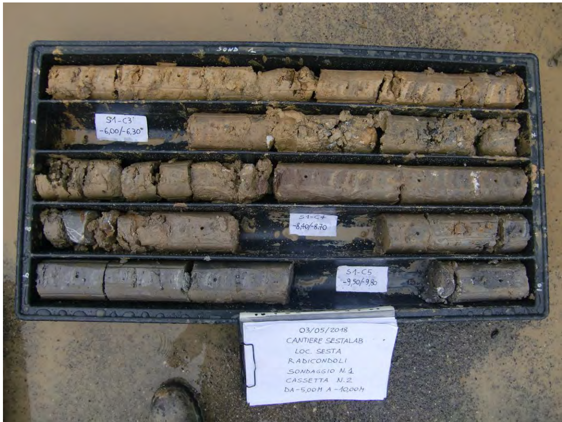
Foto n. 3: sondaggio S.1, cassetta n. 2 (da -5,00 m a -10,00 m)
