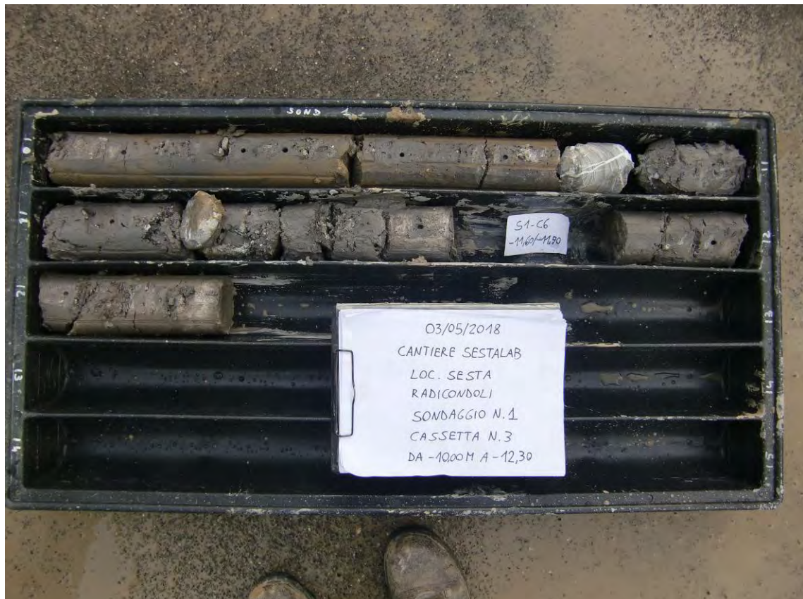
Foto n. 4: sondaggio S.1, cassetta n. 3 (da -10,00 m a -12,30 m)
