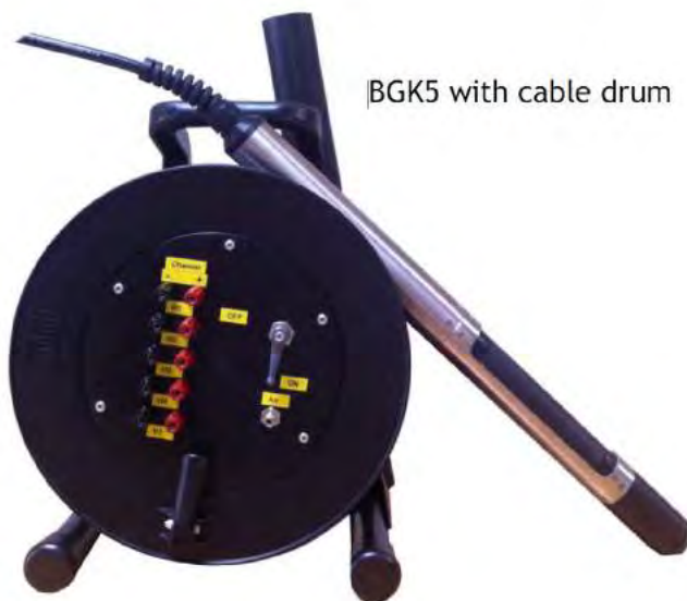
Fig. 3 Geofono da foro BGK5 per prove fino a 50 m.
