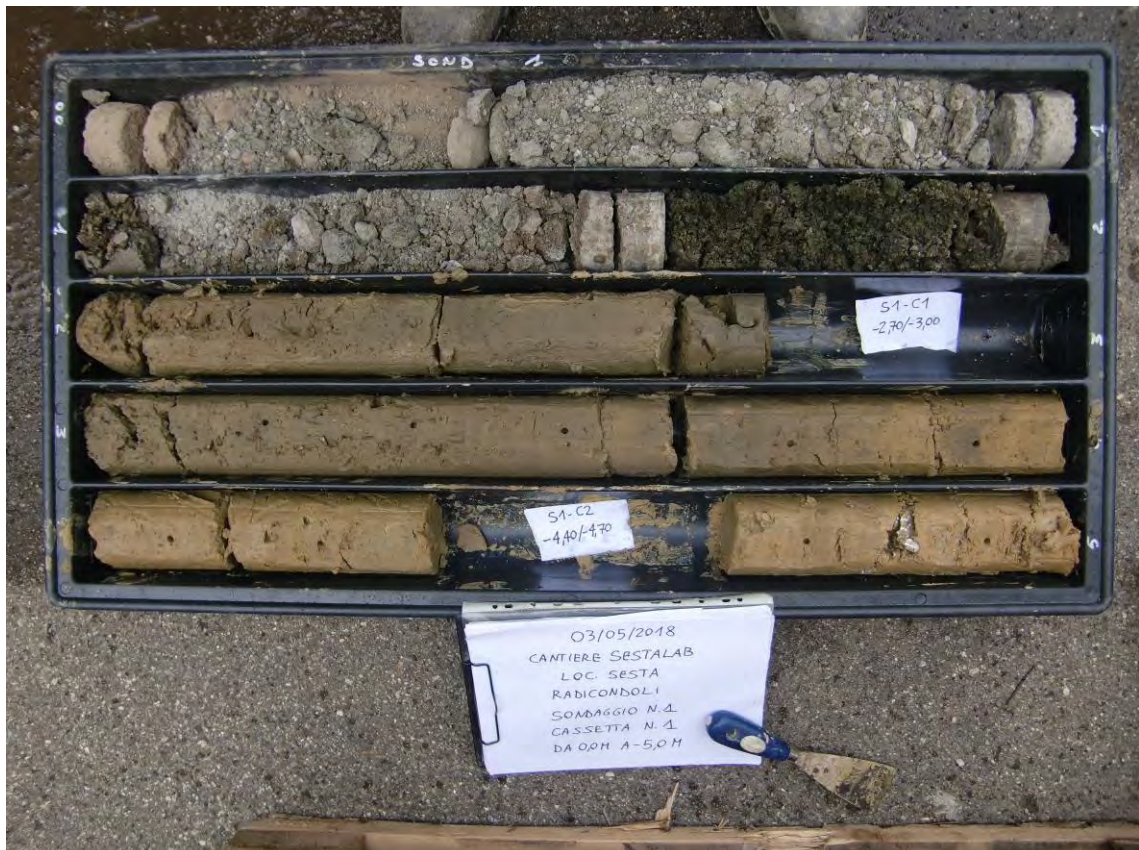
Foto n. 2: sondaggio S.1, cassetta n. 1 (da p.d.c. a -5,00 m)
